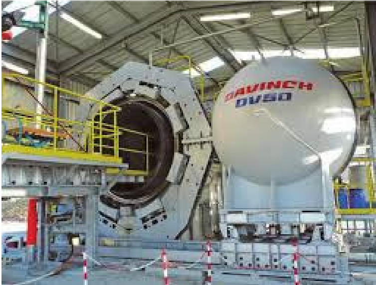
Bild 9. Exempel på en detonationskammare för destruktions av kemiska vapen (Bild: Kobelco.com).
